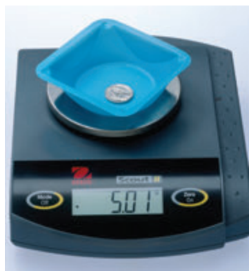
Figure 1.9 (en haut) Balance automatique d'analyse ; (au milieu) balance Roberval et (en bas) balance électronique de laboratoire. La balance Roberval nécessite que l'on place des masses de référence dans un des plateaux et, dans l'autre, l'échantillon à peser.
